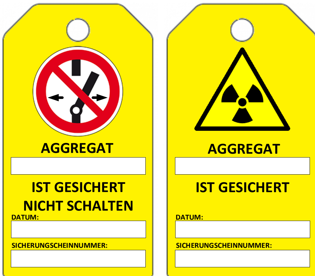
Muster für Yellow Tag für elektrische / mechanische Aggregate
